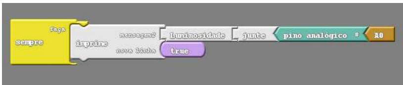
Figura 18: Exemplo de programação para leitura dos dados do LDR
