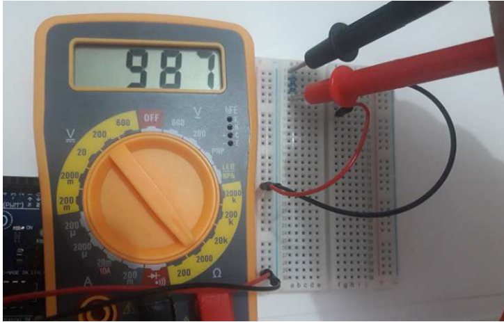
Figura 7: Medindo resistência elétrica Fonte: Do autor.
