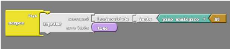
Figura 18: Estrutura de programação para fazer a leitura dos dados pelo monitor serial.
