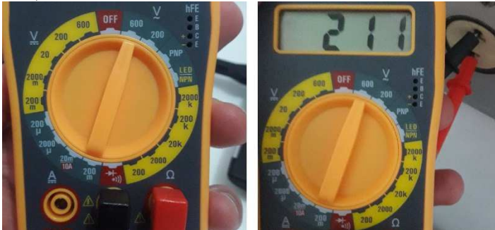
Figura 2: Medindo tensão de uma rede 220V em corrente alternada Fonte: Do autor
