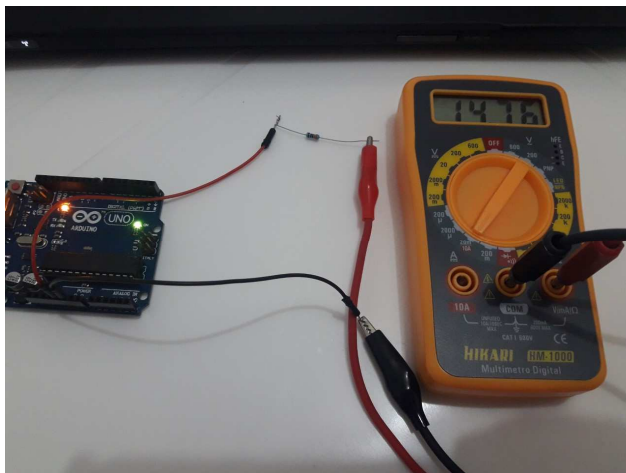
Figura 3: Medindo corrente contínua com o multímetro Fonte: Do autor
