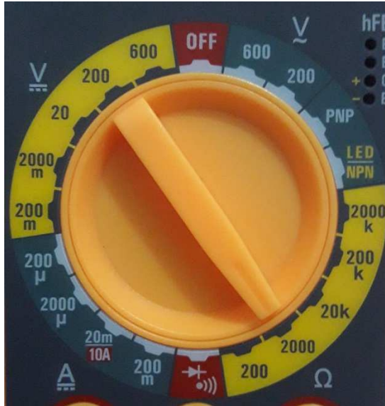
Figura 5: Chave seletora em 2000Ω Fonte: Do autor.
