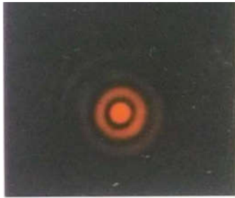
Figura 5. Fotografia da Figura de difração produzida por um disco. Nota-se que ao centro existe um ponto iluminado. Fonte: [Halliday, 2012]
